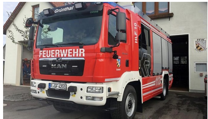
Neues Löschgruppenfahrzeug, Marke MAN, Allradfahrzeug mit 6 Zylinder, Aufbau der Firma Rosenbauer mit 2000 Liter Wasser und umfangreicher Feuerwehrausstattung. QUELLE: FREIWILLIGE FEUERWEHR GRÜNTHAL
